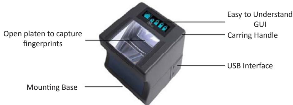
Fig. 3.1.7. Fingerprint Scanner
